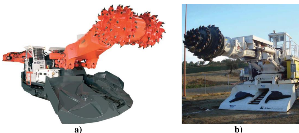
Fig.3.40. Combina: a) transversale - Sandvik MR -520; b) direcțională - WIRTH Paurat
